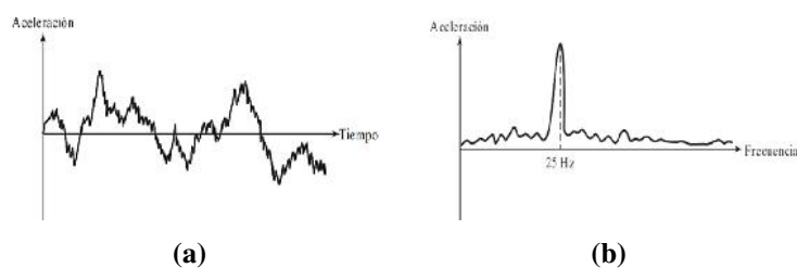
Figura 2.13. a) Señal recibida en función del tiempo, b) Señal después de aplicar el analizador de vibraciones en función de las frecuencias.
